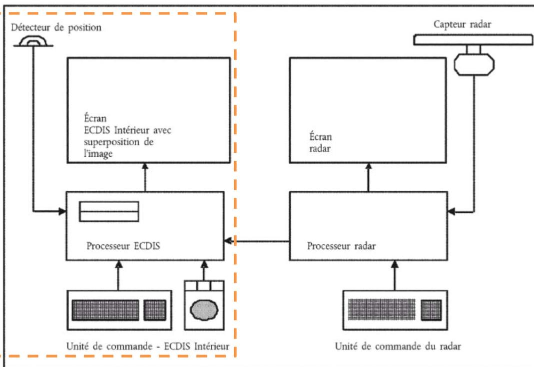
Figure 2 : Appareil ECDIS Intérieur, appareil autonome relié à l'installation radar avec écran en commun (configuration du système 3)
